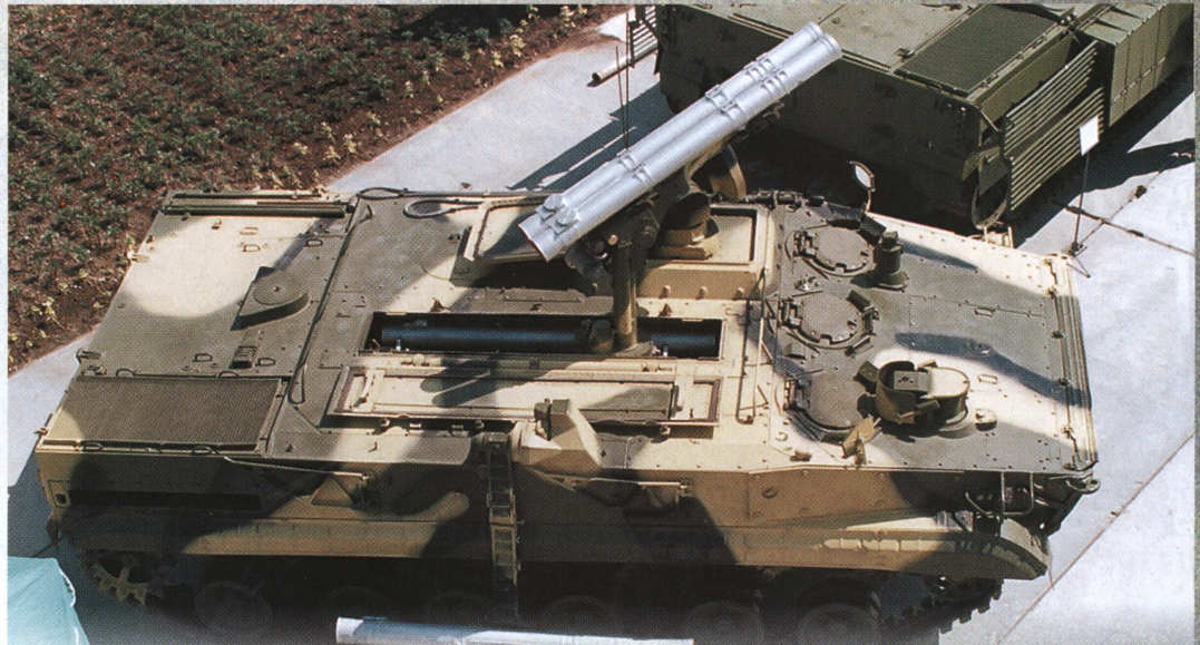
Боевая машина 9П157 с ПТРК «Хризантема», вид сверху. Хорошо видны установка с двумя ракетами и запасной контейнер внутри машины.
