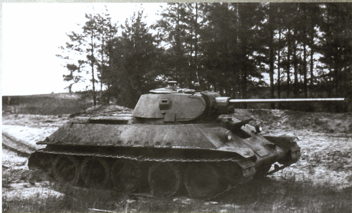
Т-34 с доработанным образцом 57-мм танкового орудия на Софринском полигоне, июль 1941 года.
