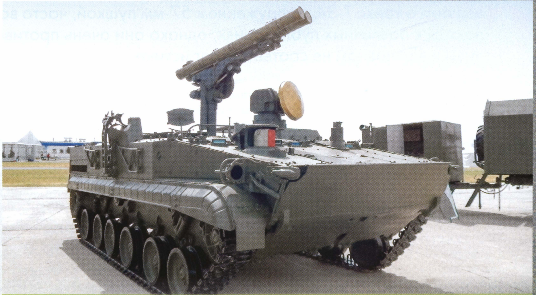
Боевая машина 9П157 противотанкового ракетного комплекса «Хризантема», общий вид.
